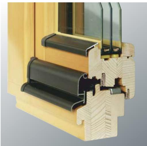
Diese ISARHOLZ-Holzfensterausführung besteht durch elegante und abgerundete Profile für behagliches Wohnen. In Verbindung mit Wärmeschutzgläsern erreicht das Fenster zur Verminderung Ihrer Energiekosten den Wert  $U_w$   $0,83 \text{ W/m}^2 \text{ K}$ .
